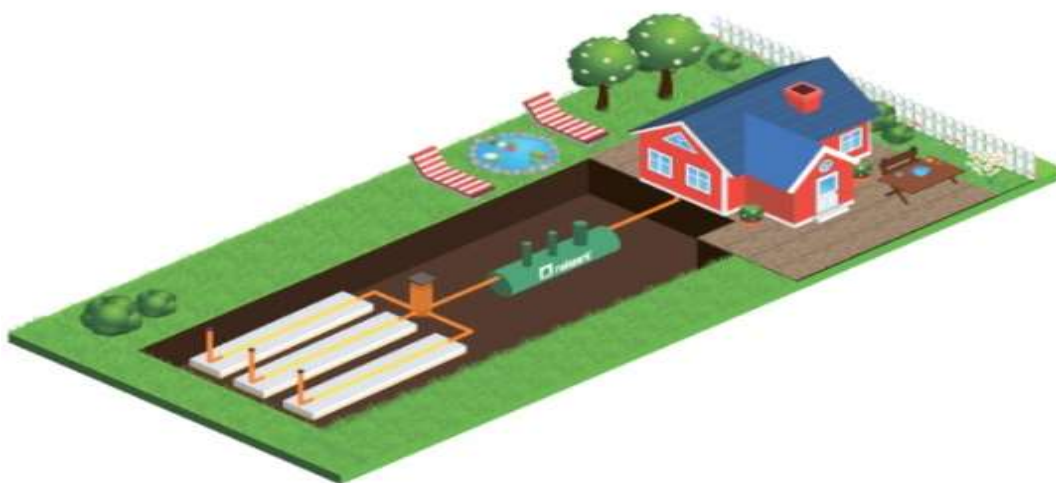
Figura 6. Schema de instalare a unei fose septice
