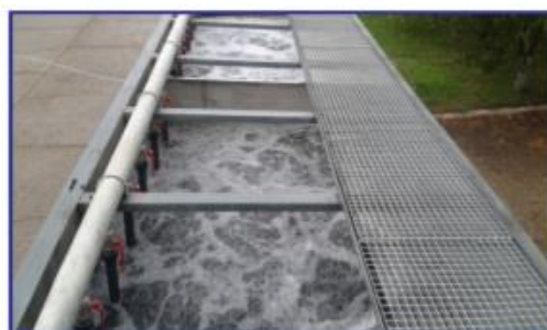
Figura 79: Stație de epurare de capacitate mică prefabricată și containerizată de la Aqua System Plus SA
