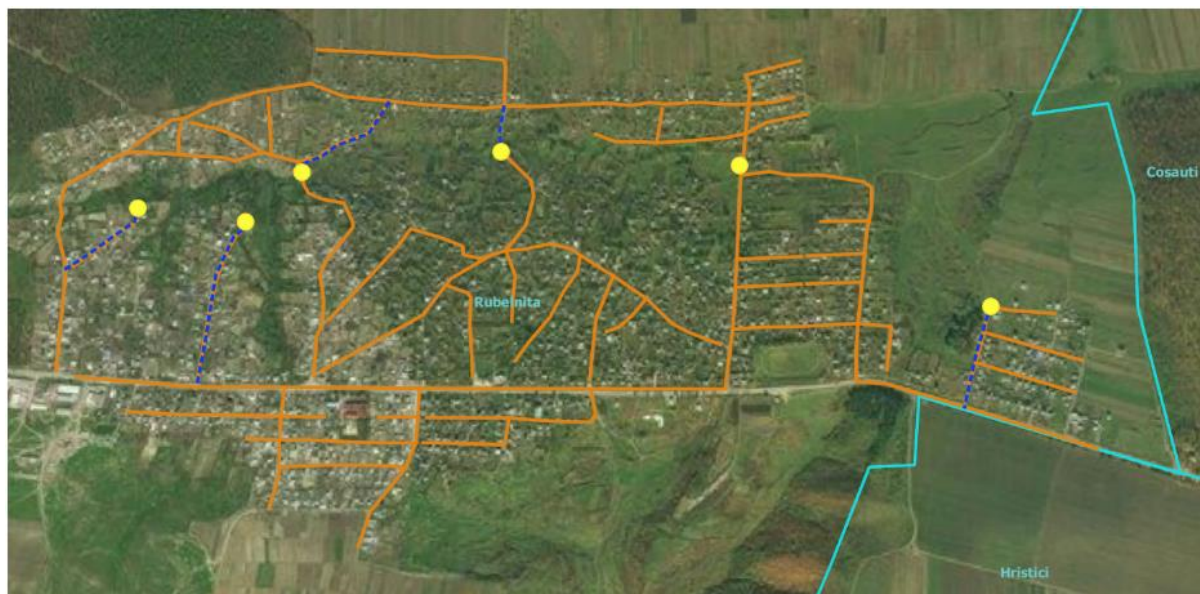
Figura 98: Rețea de canalizare în satul Rublenița
