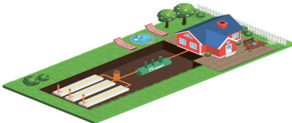
Figura 6. Schema de instalare a unei fose septice
