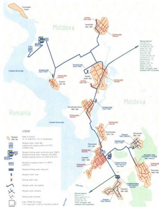
Figura 3. Schema propusă de alimentare cu apă în clusterul Prut, raionul Rîșcani
